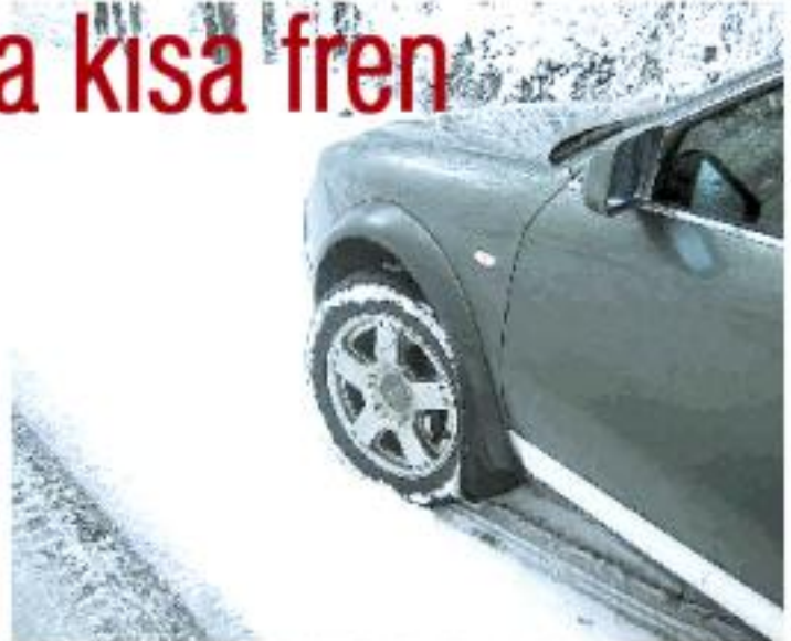
Avusturya Otomobil Kurumu ÖAMTC'nin 80 km/h ve kar üzerinde 4x4 bir araçta yaptığı fren testleri sonunda kış lastiği ile 67m, dört mevsim lastiği ile 82m ve yaz lastiği ile 108m fren mesafeleri ölçülmüştür.
